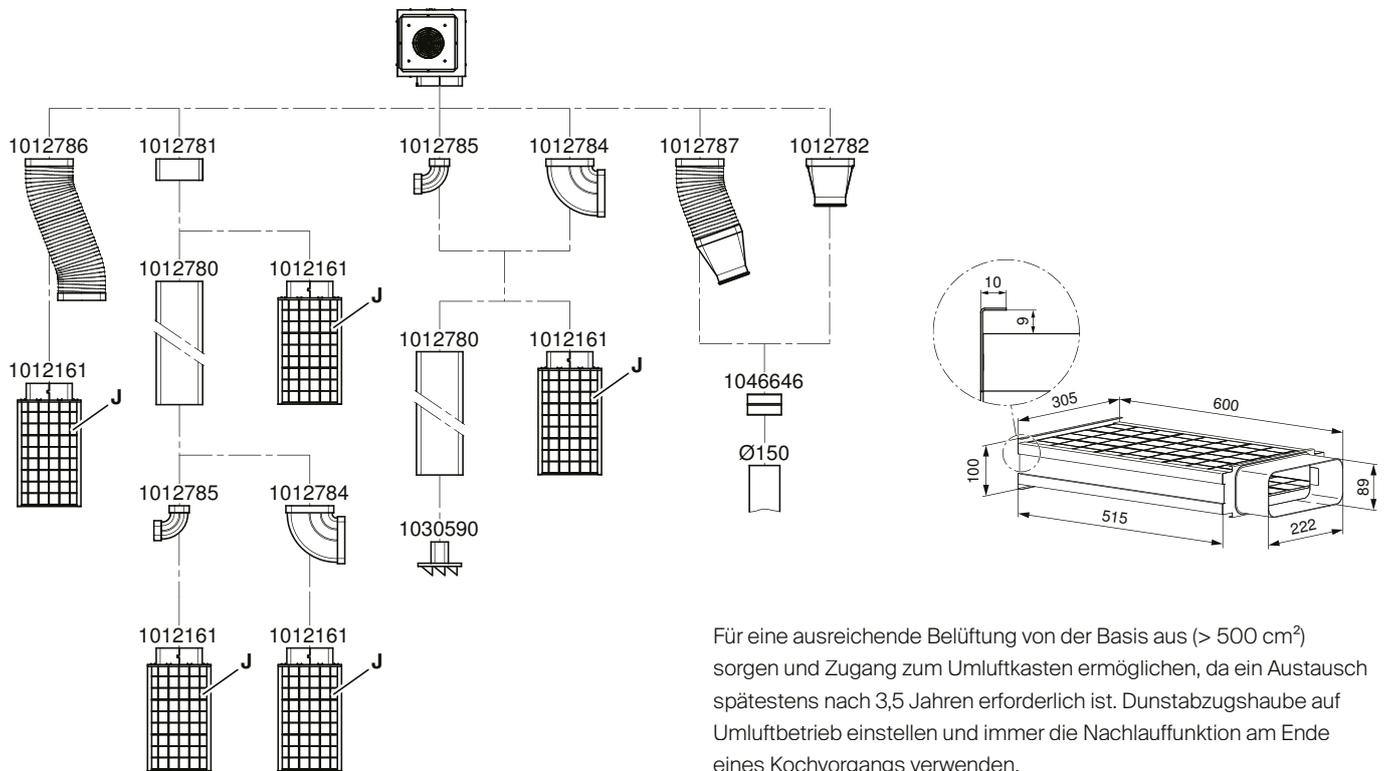
Für eine ausreichende Belüftung von der Basis aus (> 500 cm<sup>2</sup>) sorgen und Zugang zum Umluftkasten ermöglichen, da ein Austausch spätestens nach 3,5 Jahren erforderlich ist. Dunstabzugshaube auf Umluftbetrieb einstellen und immer die Nachlauf Funktion am Ende eines Kochvorgangs verwenden.
