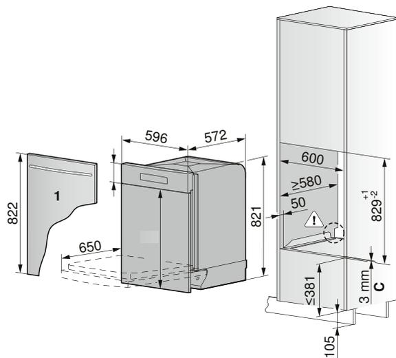
C Umbau-Set Gleitblech für den Hocheinbau muss bei V-ZUG bestellt werden, Artikel Nr. W83583
